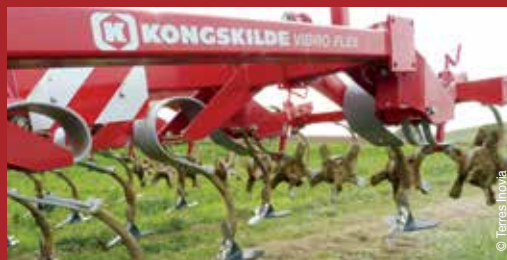
Les outils de scalpage (ici des ailettes montées sur les dents d'un cultivateur) déracinent les adventices sans pour autant remuer la terre sur plus de dix centimètres.
